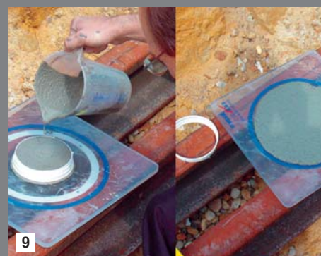
Ständige Kontrolle der Konsistenz des Vergussmörtels durch Bestimmung des Ausbreitmaßes und Herstellung von Probekörpern.
